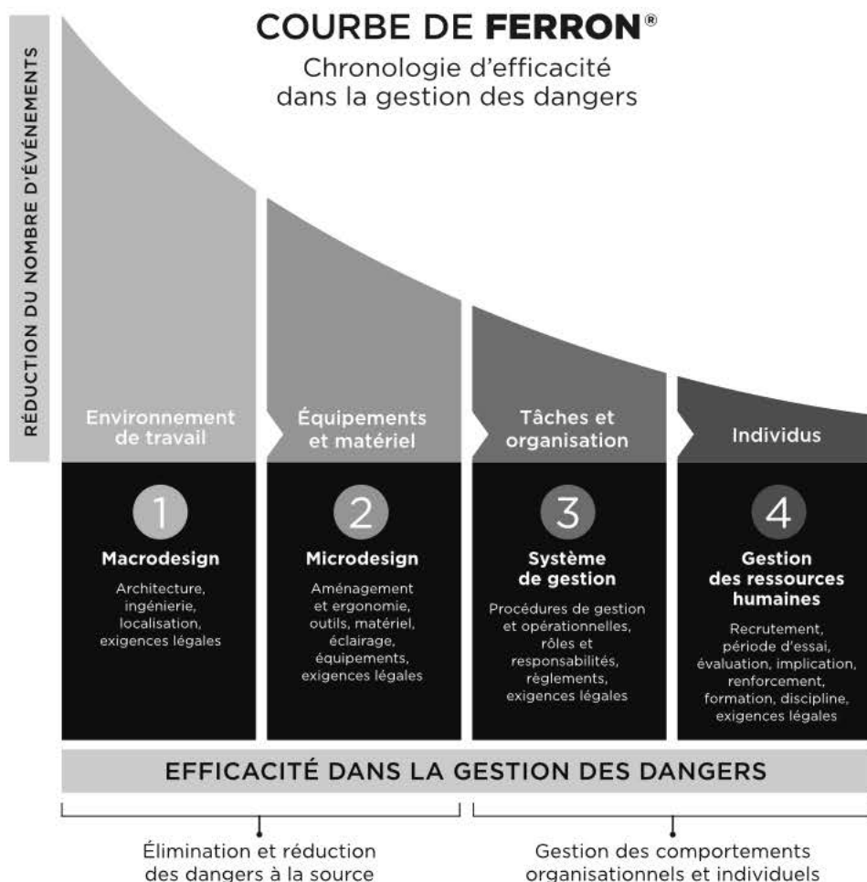
Figure 2 - Courbe de Ferron illustrant la chronologie d'efficacité en matière de gestion des dangers. Chaque organisation devrait toujours mettre des efforts en priorité sur l'élimination et la réduction des dangers à la source (éléments 1 et 2 de la figure), qui se passent dans l'environnement de travail. Il s'agit des façons les plus efficaces d'intervenir en matière de gestion des dangers.
