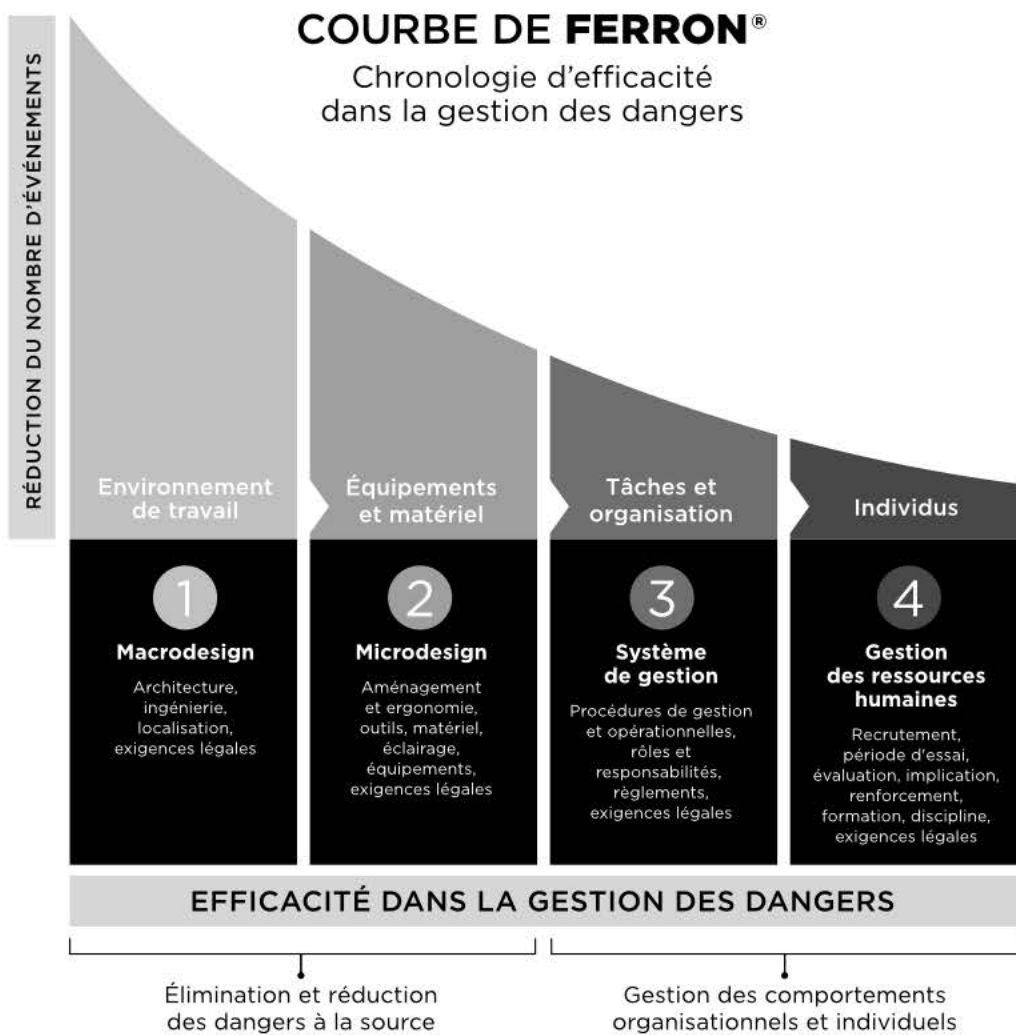
Figure 1 – Courbe de Ferron illustrant la chronologie d'efficacité dans la gestion des dangers ainsi que les types de causes pouvant générer un événement (Environnement de travail, Équipements et matériel, Tâches et organisation, et Individus)
